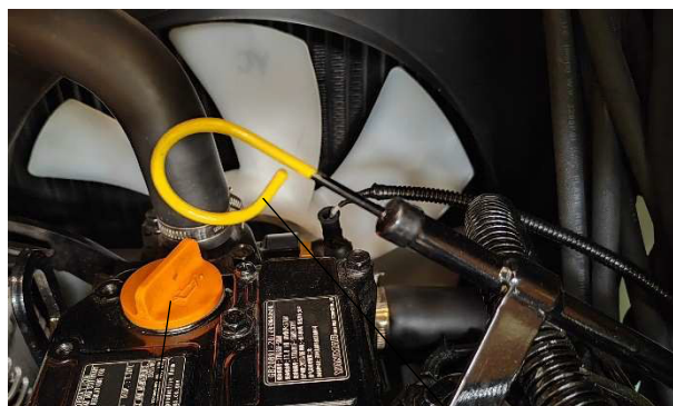
Port de remplissage
